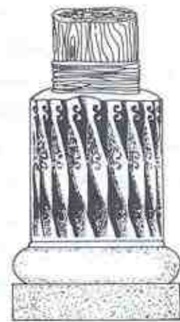
تصویر ۱۰۲ - ستونی در خزانه. بر بدنه ی تیرکی از چوب شاخه های باریک را می پیچانند و سپس روی آن را با گل اندود می کردند. روی این ستون ها با رنگ های آبی و سرخ تند و رنگ سفید نقاشی شده بود.
