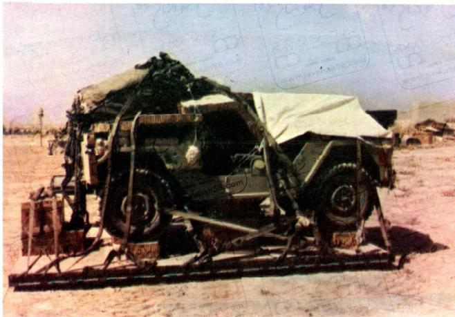
تصویری از نحوه بسته‌بندی یک دستگاه جیب حامل تفنگ ۱۰۶ میلیمتری برای پرتاب از هوا،
